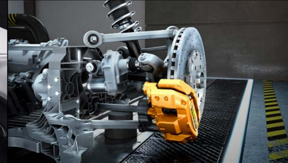
201 - Dirección del eje trasero con un ángulo de giro de hasta 2,5°
