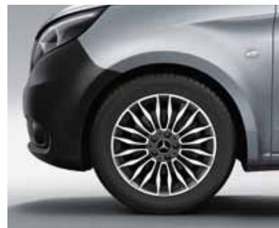
**Llantas de 10 radios dobles<sup>1</sup>**. Llantas en diseño de 10 radios dobles, color negro y pulidas a alto brillo, con neumáticos 245/45 R 18.
