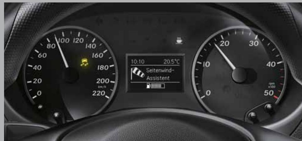
El asistente para viento lateral de serie ayuda a evitar una deriva lateral debida a la acción de viento racheado lateral.
