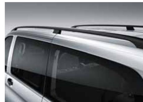
○ Las **barras longitudinales en el techo** permiten transportar cargas voluminosas sobre el techo del vehículo y revalorizan el diseño exterior.
