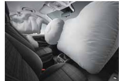
● Los **airbags frontales**<sup>2</sup> para el conductor y el acompañante, los airbags laterales de tórax y cadera y los windowbags delante forman parte del equipamiento de seguridad de serie.
