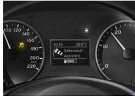
● El **asistente para viento lateral** ayuda a evitar una deriva del vehículo bajo la acción de viento racheado lateral.
