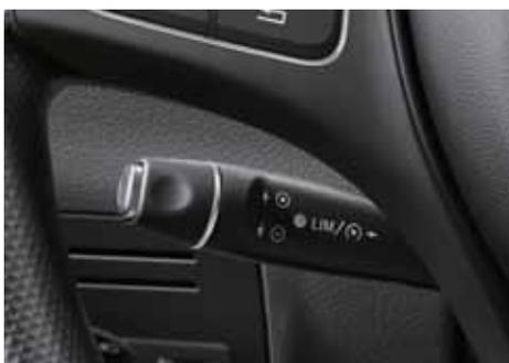
○ El **TEMPOMAT** permite mantener la velocidad ajustada y facilita la tarea del conductor.
