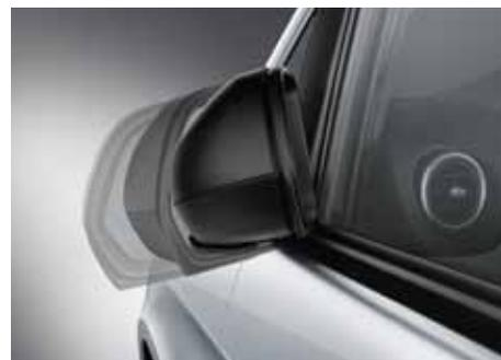
○ El **paquete de retrovisores** incluye retrovisores exteriores con función antideslumbrante automática y plegables eléctricamente.
